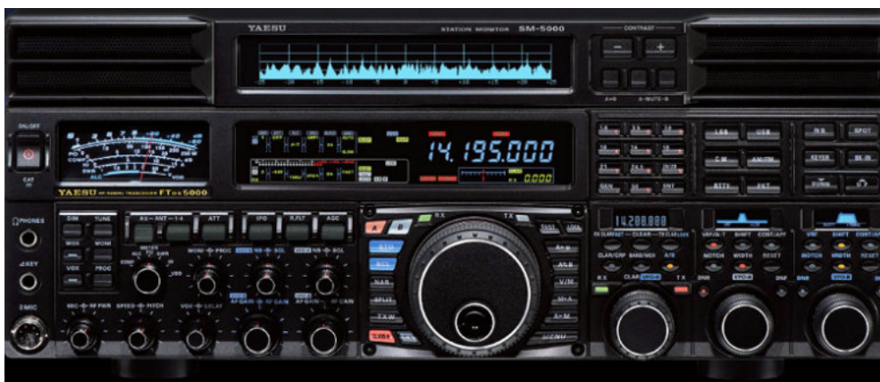
Foto: Transceptor de HF dedicado ao Serviço de Radioamador.
